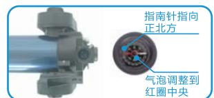
当确认“初始位置”后，安放长焦目镜（如26mm），并打开望远镜电源开关。当手控器进入简易校准后，系统会自动选择两颗星中的第一颗，并转到该星位置。
