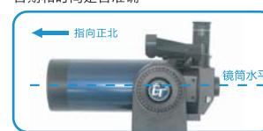
调整望远镜的镜筒到“初始位置”，使镜筒的镜筒指向正北面，且镜筒为水平状态。可以松开水平方向锁和垂直方向锁来调整初始位置，也可以使用气泡指南针来验证镜筒是否指向正北方向和水平状态。
