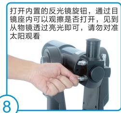
装上配件所提供的目镜，建议使用焦距较大目镜，如25mm
