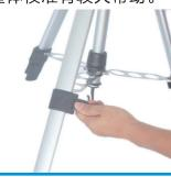
调整脚架长度后，旋转脚架锁钮锁紧三脚架。
