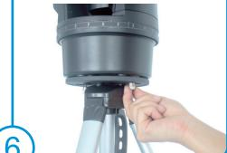
顺时针拨动水平方向锁，锁紧水平方向轴，拧紧并不能旋转望远镜即可。
